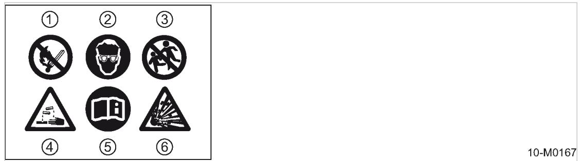
Fig. 32 Sikkerhet-advarselsmerker på batteriet
